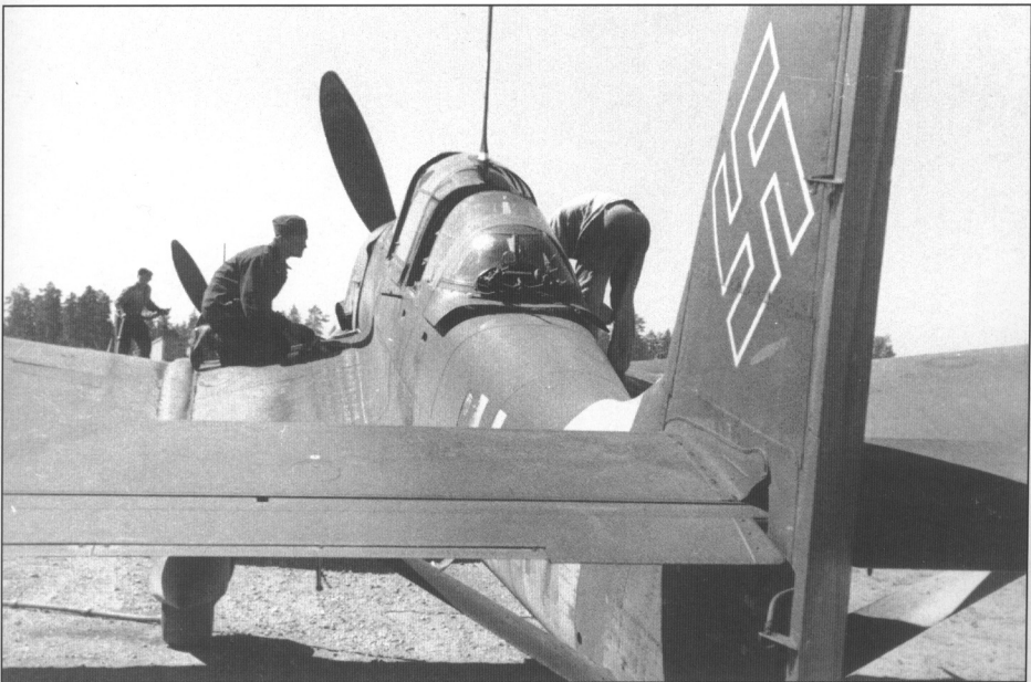
Osasto Kuhlmeyn Junkers Ju 87 D-5 syöksypommittajia huollossa Immolassa kesällä 1944. Taka-ampumossa on 7.92 mm MG 15 konekivääripari (SA-kuva).
