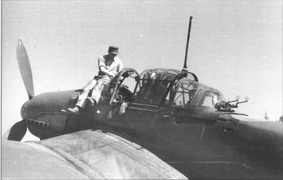
Osasto Kuhlmeyn Junkers Ju 87 D-5 syöksypommittajia huollossa Immolassa kesällä 1944. Taka-ampumossa on 7.92 mm MG 15 konekivääripari (SA-kuva).
