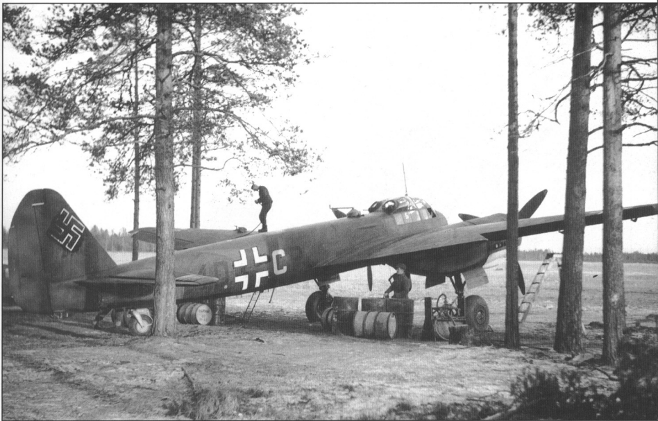
6./KG 30:n Ju 88 A-4 pommitaja 4D+CP tankattavana Nurmoilassa syksyllä 1942. Koneen alapuoli maalattiin mustaksi yölentotoimintaa varten. Moottorien alapuoli on säilyttänyt keltaisen omakonetunnuksensa (P. Saari).
