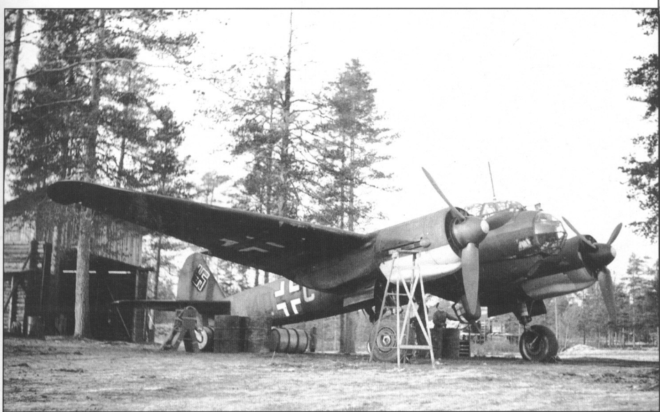
6./KG 30:n Ju 88 A-4 pommitaja 4D+CP tankattavana Nurmoilassa syksyllä 1942. Koneen alapuoli maalattiin mustaksi yölentotoimintaa varten. Moottorien alapuoli on säilyttänyt keltaisen omakonetunnuksensa (P. Saari).
